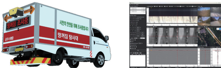
차량형 3D GPR 탐사장비와 지하공동 해석 소프트웨어 GPR Core
